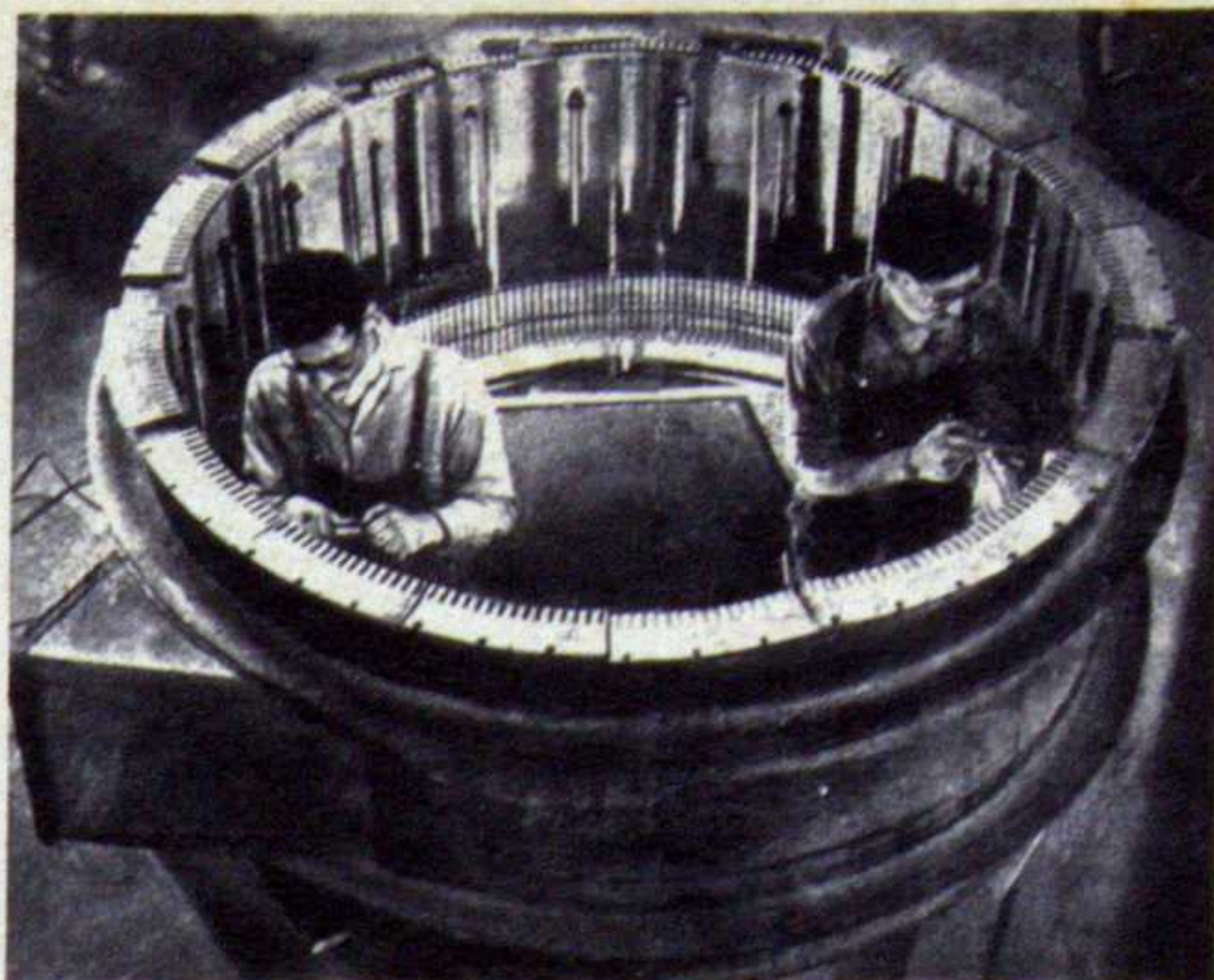
Armado del inducido de un alternador para 1200 KVA, 3000 r. p. m. en los talleres de Electrodinic. E. N. Industria Eléctrica.
