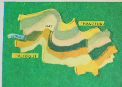
El esquema muestra dos casos muy comunes: uno en que puede verse un anticlinal sin fractura; otro afectado por una falla.
